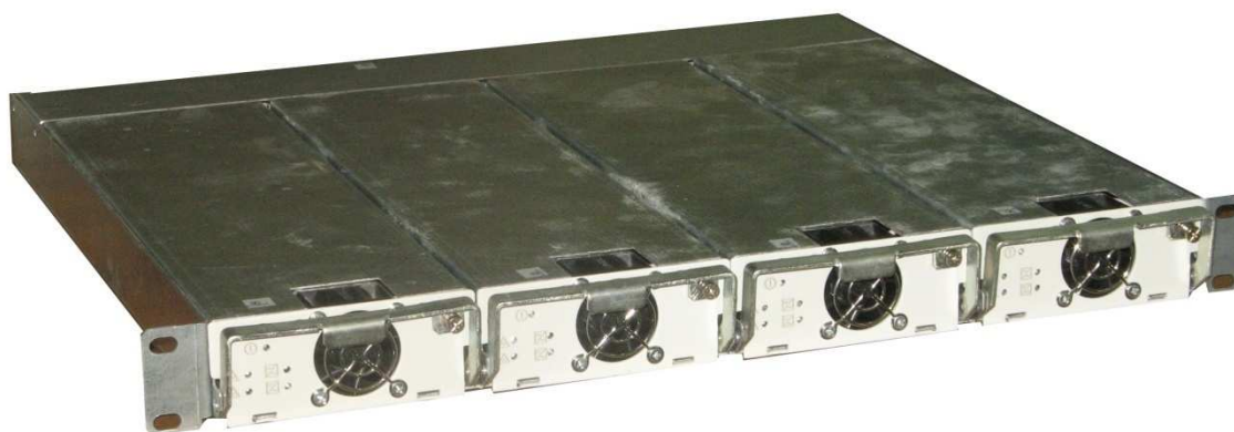
Рисунок 2.6 – Модульный каркас Штиль PS500K с инверторами Штиль PS48-60/500K (PS48-60/500K (I))
